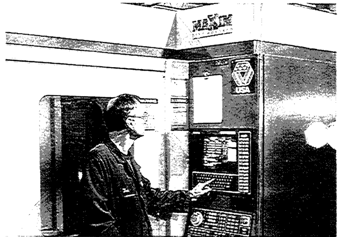
El Cincinnati Milacron Maxim, un centro de maquinado horizontal de cuatro ejes, es una de las nuevas máquinas herramientas de Corkin.
