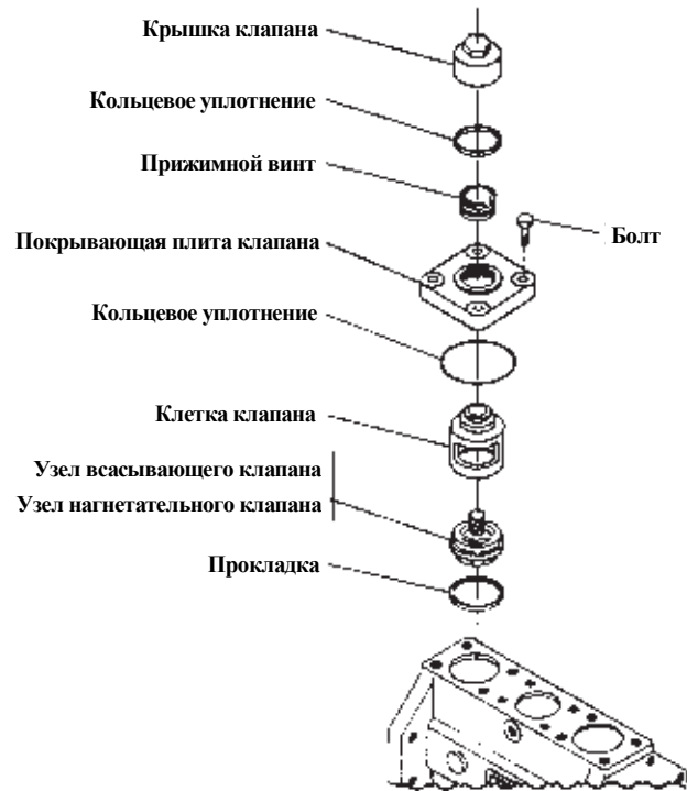
РИС. 2. Разборка клапана
